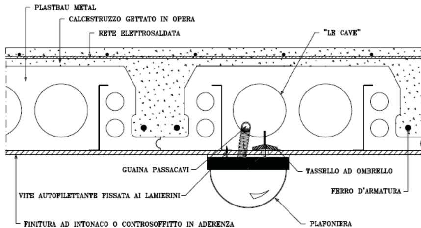
Fitting für die Aufhängung von leichtgewichtigen Beleuchtungskörpern nach Fertigstellung des Bodens, mit einer nicht anliegenden Zwischendecke. Schirmförmige Ankerhülse, die an der Gipskartonplatte befestigt wird, mit elektrischen Drähten in den Löchern des **Plastbau® Metall-Bodens**: siehe Schema unten
