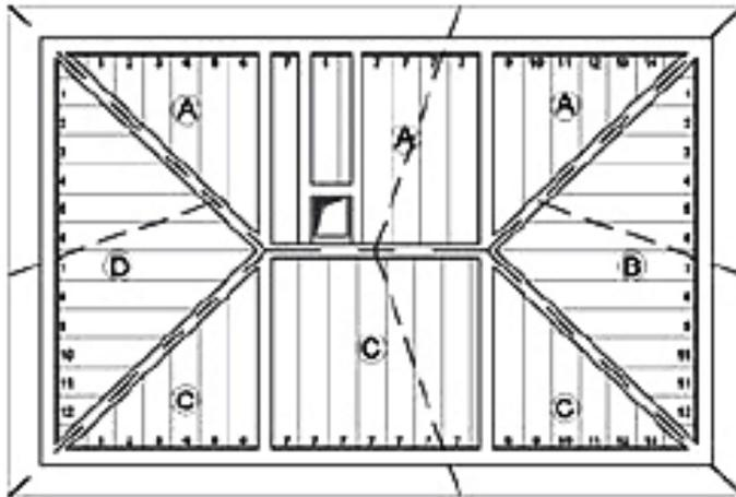
Die Paneele werden mit einer minimalen und maximalen Neigung von 6° bzw. 53° geliefert (minimaler Unterschied zwischen größerer und kleinerer Länge 6cm; maximaler Unterschied zwischen größerer und kleinerer Länge 78cm).
