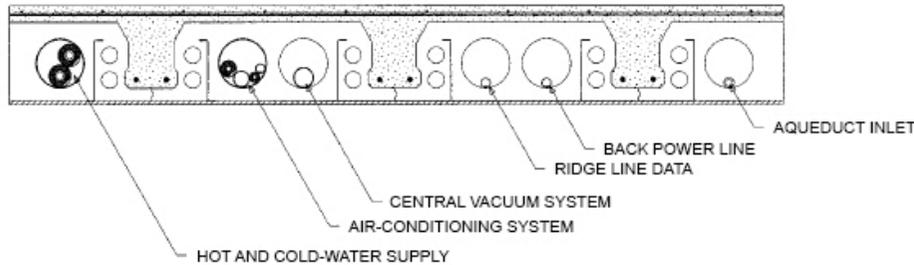
Darüber hinaus kann die Plattenstärke optimiert werden, da sämtliche Installationen in den Längslöchern der Paneele vorgenommen werden können, wodurch die Stärke der Bodeninnenseite auf das absolute Minimum reduziert wird. Durch eine Zapfenverbindung der Paneele wird ein Träger erzeugt, der die Kerngitter (gerade, stumpf und geformt) aufnimmt, die in das **Plastbau® Metall-Gussteil** eingearbeitet werden. Auf diese Weise werden Wärmebrücken vermieden.
