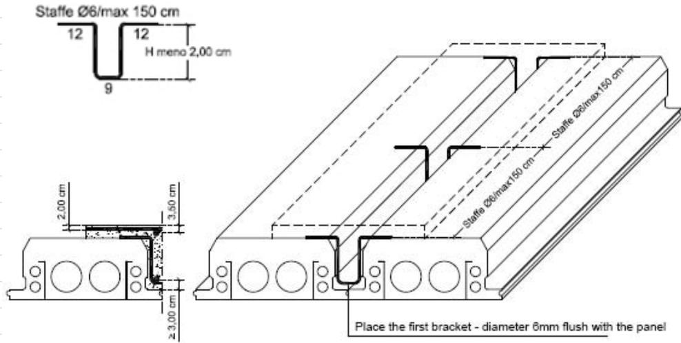
Der obere Bewehrungsstab der Balken wird in Höhe der Ständer positioniert und unterhalb des elektrogewweißten Stahlgitters angebunden.
